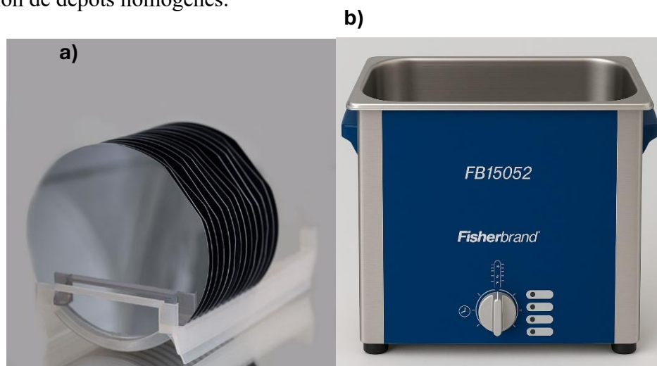
Figure 32 : a) Wafer de silicium et b) nettoyeur à ultrasons des substrats .
