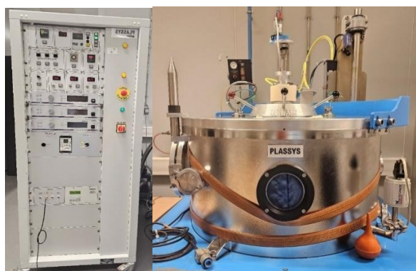
Figure 14 : Photo de l'ensemble du bâti de pulvérisation MP600 commercialisé par la société Plassys (à gauche l'armoire électrique contenant les générateurs, à droite l'enceinte de dépôt).
