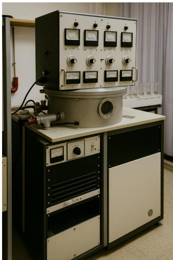
Figure 33 : Photographie de l'ensemble du bâti de pulvérisation MRC pour la métallisation des substrats.
