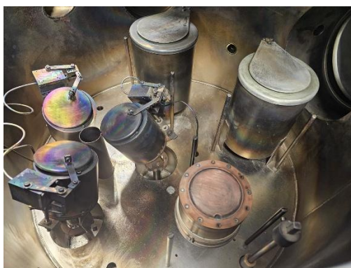
Figure 15 : Photo de l'intérieur de l'enceinte du bâti de pulvérisation Plassys MP600 contenant 3 cathodes et un bloc de copulvérisation.
