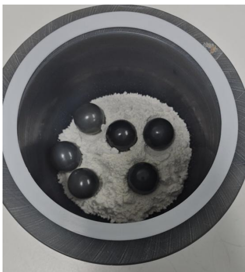
Figure 72 : Jarre et billes en agate pour faire le broyage des poudres \text{ZnO} et \text{Y}_2\text{O}_3 .
